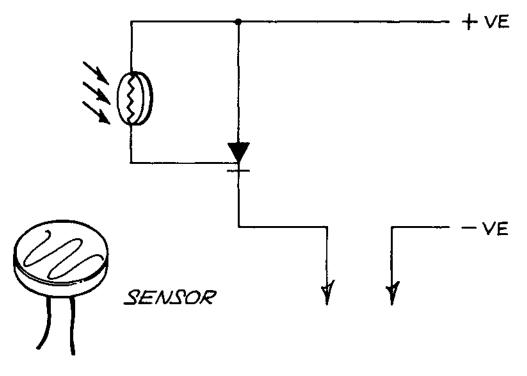
FIG. 80 LIGHT - SENSITIVE SWITCH
