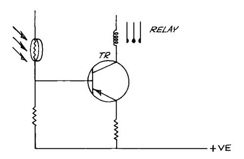
FIG. 81 LIGHT - SENSITIVE SWITCH
