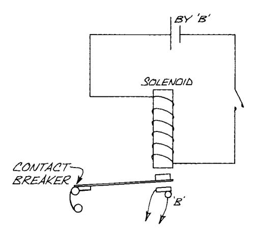
FIG. 53 SOLENOID & CONTACT BREAKER
